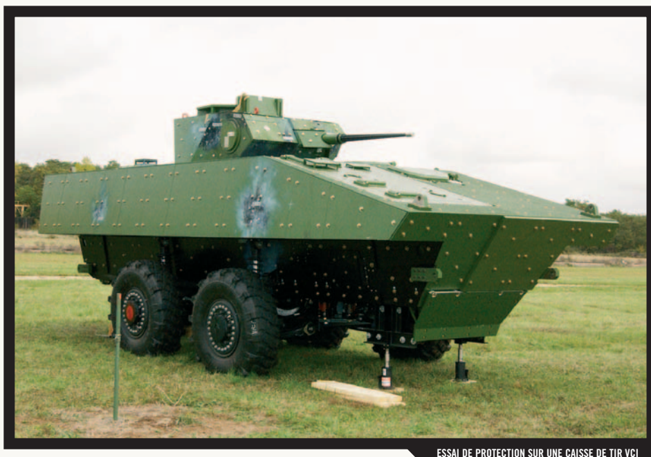
ESSAI DE PROTECTION SUR UNE CAISSE DE TIR VCI
