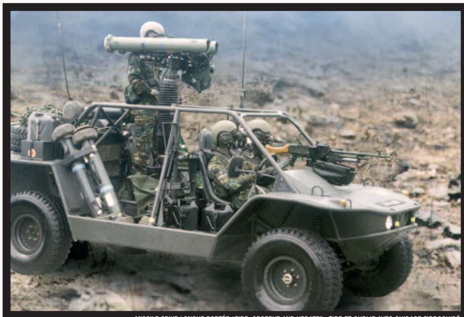
MISSILE SPIKE LONGUE PORTÉE "FIRE, OBSERVE AND UPDATE" : TIRE ET OUBLIE AVEC GUIDAGE FIBROGUIDÉ
