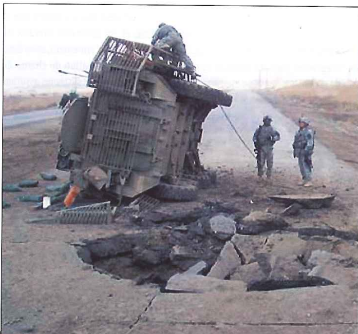
Le Stryker souffre particulièrement face aux IED, les Improvised explosive devices. Sa masse est déjà en soi un handicap, car l'engin reste trop léger et est "soufflé" même si son blindage n'est pas perforé. Source : C-52 of 3/2 Stryker Brigade Combat Team
