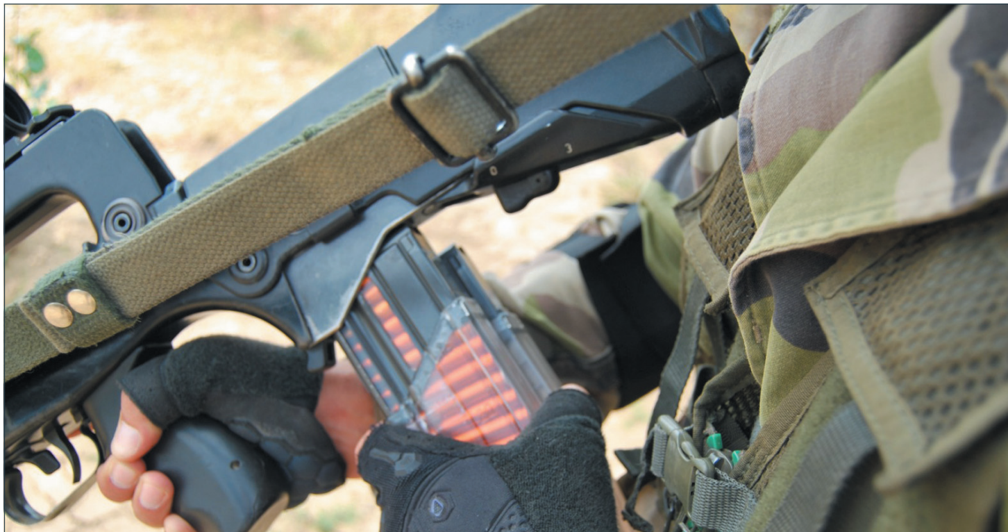
Une innovation développée dans le cadre de la MIP : le chargeur FAMAS transparent
