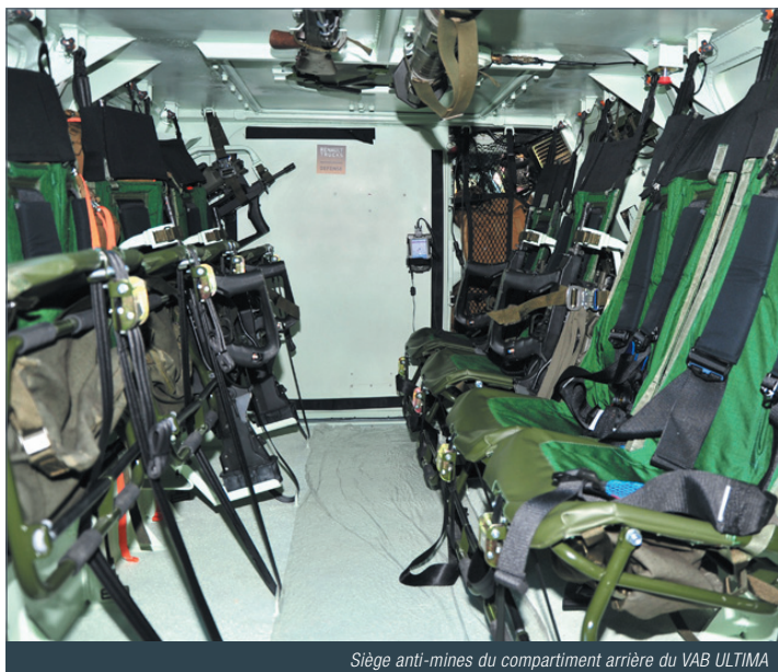
Siège anti-mines du compartiment arrière du VAB ULTIMA
