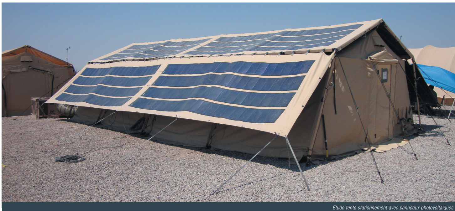
Etude tente stationnement avec panneaux photovoltaïques
