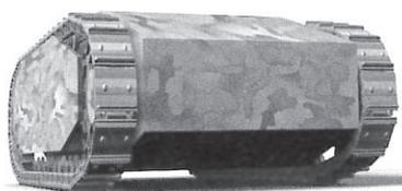
Le premier robot de combat a fait son apparition au cours de la seconde guerre mondiale du côté allemand. Le "GOLIATH" était un petit véhicule chenillé télécommandé grâce à un câble de 600 m et transportant une charge explosive de 50 kg destinée principalement à la destruction de positions fortifiées.
